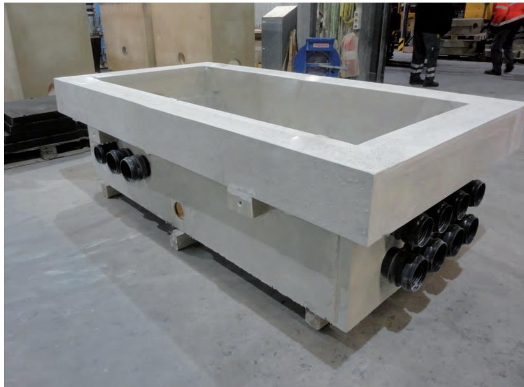
Standard-Kabelschächte werden auch ohne integrierte Anschlüsse gefertigt und geliefert, so dass der Schacht bauseits auf bestehende Leitungen versetzt werden kann.
