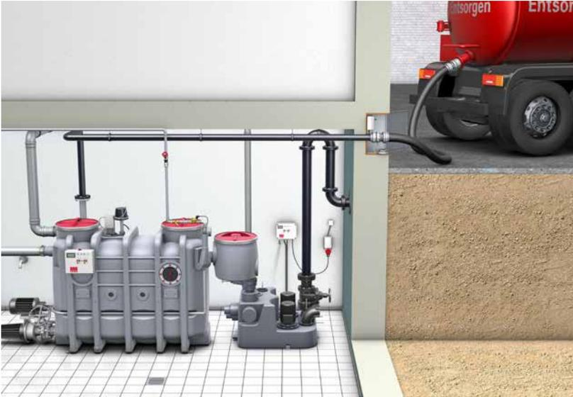
Le séparateur de graisses à évacuation complète fonctionne de manière purement physique avec la force de gravité (différence de densité), c.-à-d. que les sédiments lourds contenus dans les eaux usées tombent au fond du séparateur et les substances légères (p.ex.: huiles et graisses animales) remontent à la surface. Les eaux usées nettoyées sont conduites au réseau d'assainissement par l'embout d'écoulement.
