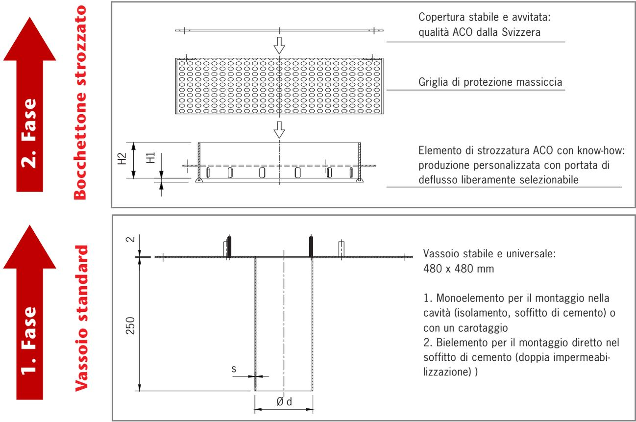
**Fatevi consegnare nel cantiere prima il vassoio standard (a magazzino) e solo in una data successiva l'unità di ritenzione!**
